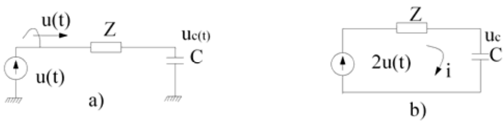
Hình 2.22: Sóng U_t dạng bất kỳ tác dụng lên điện dung C đặt ở cuối đường dây.
